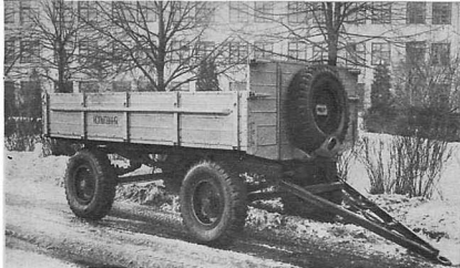
Прицеп 754-В производства Ирбитского автоприцепного завода, предназначенный для буксировки автомобилями ЗИЛ-150, ЗИЛ-164, ЗИЛ-157.
