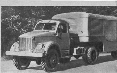
Автопоезд, состоящий из тягача ГАЗ-51 П и полуприцепа-фургона ПАЗ-744, выпускаемого Павловским автобусным заводом. Грузоподъемность 4 т.
